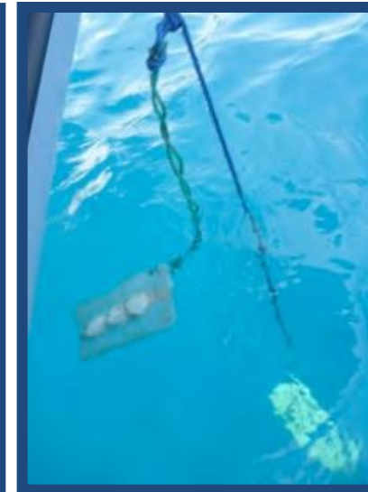
Echantillonneurs passifs en cours d'installation
